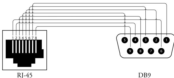
Hinweis: Das Cat 5-Kabel mit Anschluss, das für den Adapter verwendet wird und in den RJ-45-Port an der Geräterückseite, muss eine Pin-auf-Pin-Verdrahtung nutzen.
