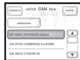
Evidenziando un componente nella schermata CAN-Bus devices la identificherete come **target unit**. Il LED sul pannello frontale della target unit comincerà a lampeggiare (a meno che l'unità scelta sia la stessa da cui state controllando il CAN-Bus).
