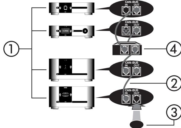
NOTA: La catena potrebbe necessitare la terminazione con un Terminator CAN-Bus.
