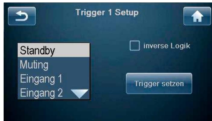
Die Trigger können mit Standby, einer speziellen Quelle oder einer Konfiguration zugeordnet werden. Um die Inverse Logik-Option nutzen zu können, setzen Sie einfach einen Haken in das entsprechende Kästchen auf der Trigger Setup-Seite.
