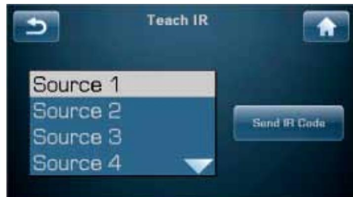
Der Bildschirm **Sende IR-Codes** bietet eine Liste mit allen im CP-800 zur Verfügung stehenden IR-Codes. Scrollen Sie bis zu dem Befehl, den Ihre makrofähige Fernbedienung lernen soll. Drücken Sie anschließend die Taste **Sende IR-Codes**. Der CP-800 sendet den entsprechenden Code über die Gerätefront aus. Er kann dann von der makrofähigen Fernbedienung gelernt werden.
