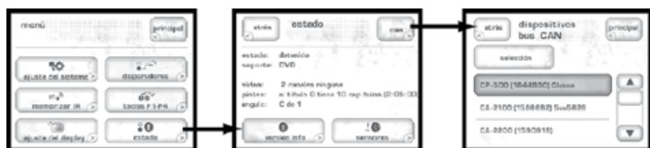
A continuación, la pantalla táctil mostrará la pantalla dedicada a los **dispositivos conectados al Bus CAN** (“**CAN-Bus devices**”) en la que figura una lista con el nombre y el número de serie de los componentes de la serie Delta/CT englobados en el mismo.
