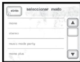
Si toca una cualquiera de las **flechas arriba/abajo** logrará que la lista se mueva en la dirección por usted indicada. Toque cualquier modo (que no esté sombreado) para seleccionarlo. El modo de procesado del SSP cambiará al nuevo modo seleccionado. Pulse el botón **Atrás** para volver a la página Principal. Los modos disponibles se describen en la Tabla 2.
