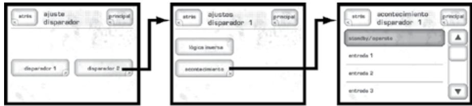
El botón Evento (“Event”) se utiliza para asignar la activación del disparador de señal a un evento específico. Los circuitos de señal de disparo pueden asociarse con el modo de Espera (“Standby”), una entrada específica, una configuración, la activación de un modo de procesado de sonido envolvente o incluso una combinación de ambos. Para utilizar la opción Lógico Inverso (“Inverse Logic”), basta con que resalte el botón Lógico Inverso de la página de ajustes Circuitos de Disparo.
