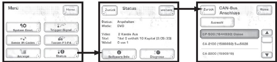
Auf dem Touchscreen erscheint der Bildschirm **CAN-Bus Anschluss**, in dem die angeschlossenen Geräte mit Modellname und Seriennummer aufgelistet werden.
