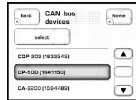
选择CAN总线装置屏幕上的一台设备，将其设为目标设备。目标设备的前面板LED显示屏幕将开始闪烁（除非您选择的设备是您用于访问CAN总线的设备）。
