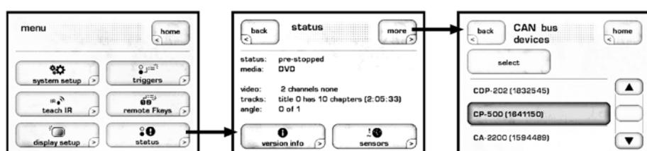
这时，触摸屏会显示**CAN-Bus devices**（CAN总线设备）屏幕，屏幕按机型和序列号列出已经连接的设备。
