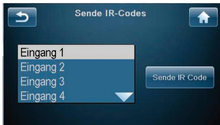
Der Bildschirm **Sende IR-Codes** bietet eine Liste mit allen beim SSP zur Verfügung stehenden IR-Codes. Scrollen Sie bis zu dem Befehl, den Ihre makrofähige Fernbedienung lernen soll. Drücken Sie anschließend die Taste **Sende IR-Codes**. Der SSP sendet – solange die Taste gedrückt wird – den entsprechenden Code über die Gerätefront aus. Er kann dann von der Fernbedienung eines Drittanbieters gelernt werden.
