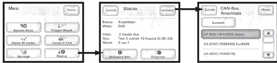
Auf dem Touchscreen erscheint der Bildschirm **CAN-Bus Anschluss**, in dem die angeschlossenen Geräte mit Modellname und Seriennummer aufgelistet werden.
