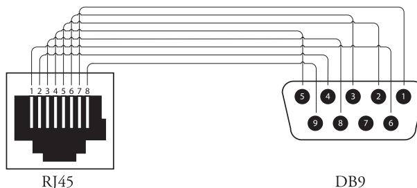
Hinweis: Beim Cat 5-Kabel muss der Stecker, der für den Adapter verwendet und mit dem RJ45-Port an der Geräterückseite verbunden wird, eine Pin-auf-Pin-Verdrahtung nutzen (Pin eins auf Pin eins, zwei auf zwei usw.).
