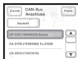
Wählen Sie ein Gerät auf dem Bildschirm CAN-Bus Anschluss aus, so wird es damit zum **Zielgerät**. Die LEDs an der Gerätefront des Zielgerätes beginnen zu blinken (es sei denn, Sie wählen gerade das Gerät aus, mit dem Sie auf den CAN-Bus zugreifen).
