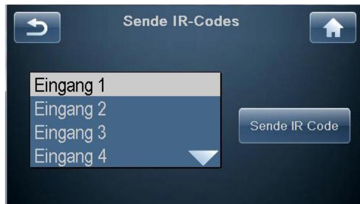
Der Bildschirm **Sende IR-Codes** bietet eine Liste mit allen beim SSP MkII zur Verfügung stehenden IR-Codes. Scrollen Sie bis zu dem Befehl, den Ihre lernfähige Fernbedienung lernen soll. Drücken Sie anschließend die Taste **Sende IR-Codes**. Der SSP MkII sendet – solange die Taste gedrückt wird – den entsprechenden Code über die Gerätefront aus. Er kann dann von der Fernbedienung eines Drittanbieters gelernt werden.
