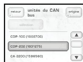
Le fait de mettre en surbrillance la ligne correspondant à un de ces appareils le désigne comme **l'appareil cible**. Les diodes de cet appareil se mettent alors à clignoter (sauf s'il s'agit de l'appareil dont vous utilisez l'écran pour ces réglages).
