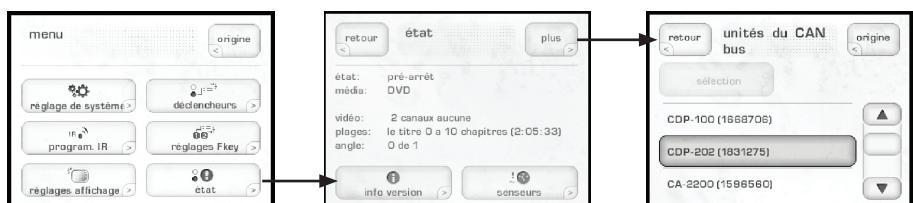
L'écran tactile va alors afficher les différentes unités présentes sur le réseau CAN-Bus (**CAN-Bus Devices**), c'est-à-dire tous les appareils reliés selon ce principe avec leur modèle et leur numéro de série.
