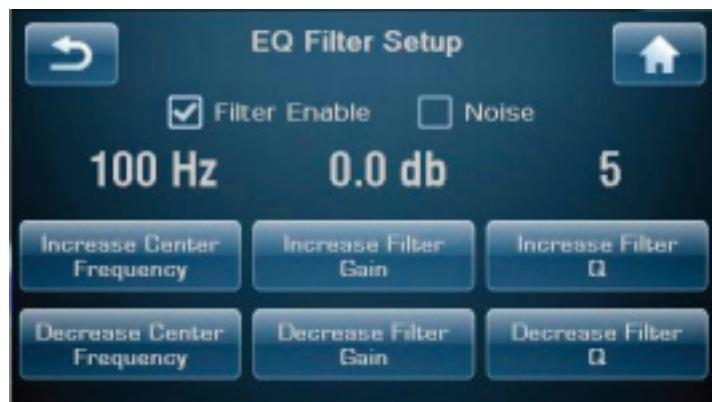
Il n'est pas nécessaire de définir obligatoirement des filtres pour chaque canal. Le technicien n'effectuera que les corrections réellement nécessaires, pour certains canaux, en fonction de l'acoustique de la pièce. *Nous vous conseillons vivement de vous adresser à votre revendeur agréé Classé pour réaliser la calibration audio de votre installation et ajuster correctement les paramètres de l'égaliseur paramétrique.*
